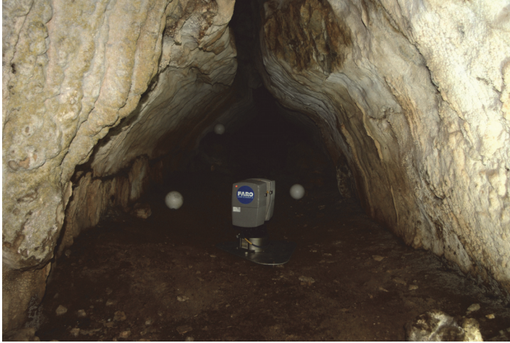
FIG. 6. Escaneo 3D de paredes.
